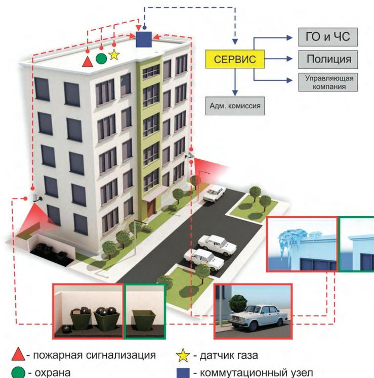
Рисунок 10. Пример реализации автоматического контроля придомовых территорий.
